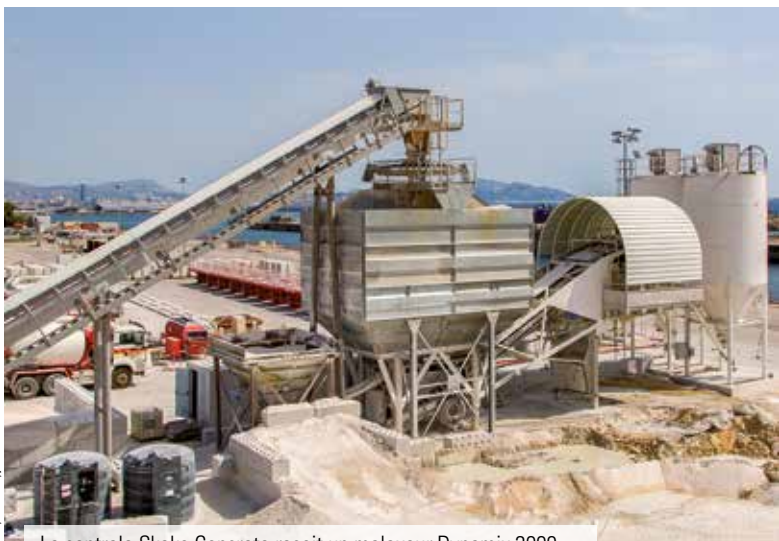
La centrale Skako Concrete reçoit un malaxeur Dynamix 3000 de 2 m 3 , capoté pour se protéger du mistral.
