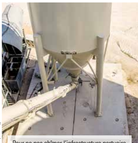
Pour ne pas abîmer l'infrastructure portuaire, les silos sont posés sur des blocs en béton et un lit de tout-venant.
